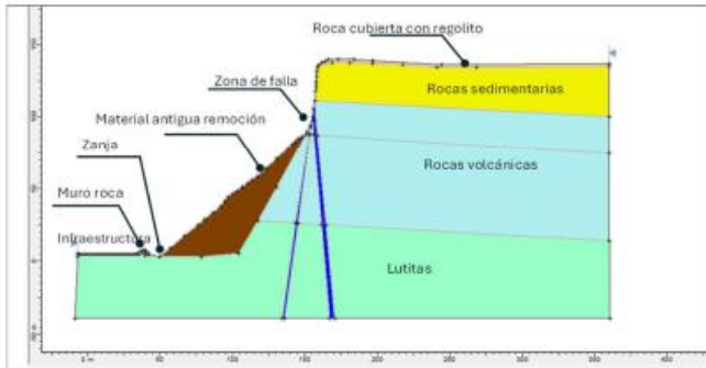
Figura 3-5 Modelo geológico – geotécnico sección 5 de análisis (zona de remoción en masa y zanja).
