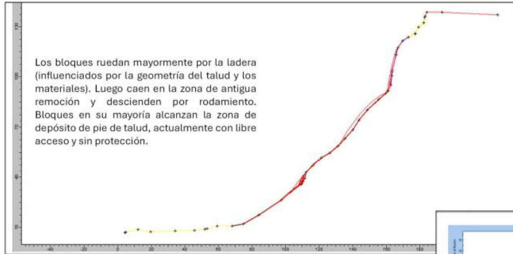
MODELO PARA CAÍDAS DE ROCAS SECCIÓN 3
