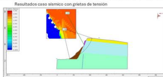
Figura 3-22 Ejemplo de análisis de deslizamientos Sección 3 zona de roca fracturada.
